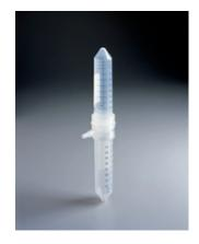
Вакуумные фильтрующие элементы Стерифлип используют с 50 мл центрифужными пробирками. Для фильтрования присоедините устройство к пробирке с образцом, переверните и подключите вакуум. По окончании фильтрат собирается в подсоединенную 50мл центрифужную пробирку.
