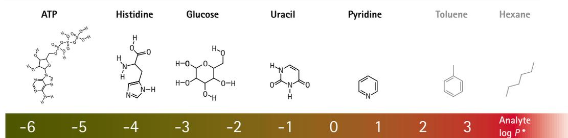
Примеры полярных и гидрофильных соединений с различными значениями  $\log P^*$ , которые могут быть разделены с помощью ZIC®-HILIC. Для сравнения, два соединения, которые очень гидрофобные для удержания (толуол и гексан) тоже в этом списке (\* = коэффициент разделения октанол/вода)
