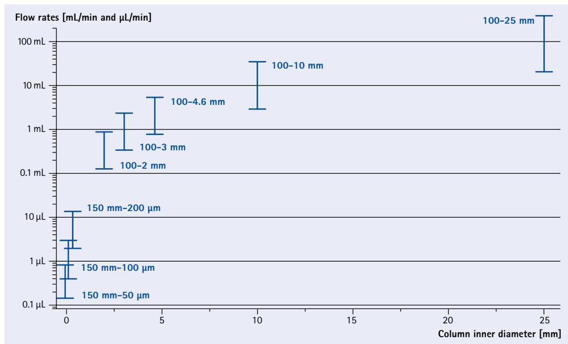
Колонка Chromolith® длина 100 мм для 2 мм, 3 мм, 4.6 мм, 10 мм и 25 мм внутренний диаметр
