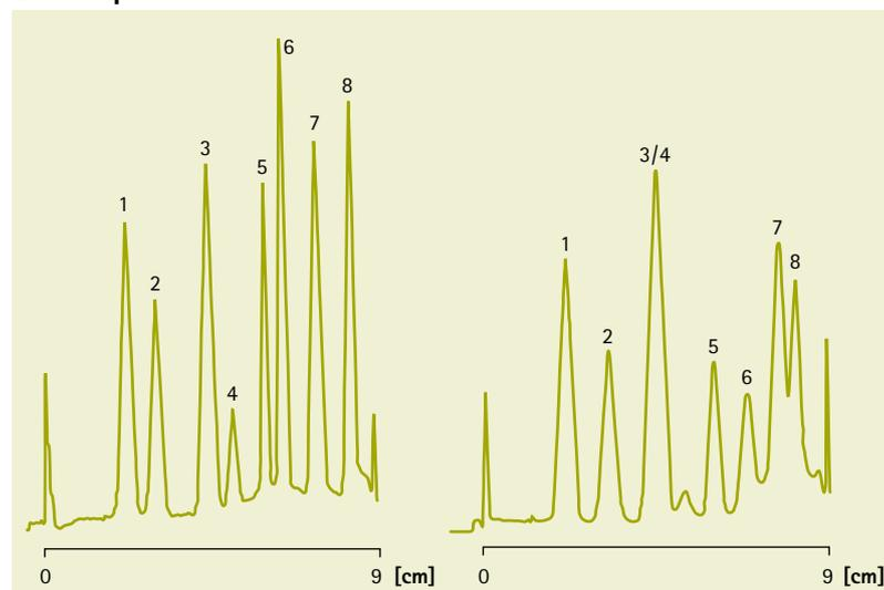
Разделение пестицидов на (А) ВЭТСХ LiChrospher® и на обычной (В) ВЭТСХ пластине демонстрирует, что использование LiChrospher® пластин позволяет разделить большее количество соединений.
