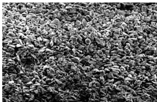
Снимки электронного микроскопа поперечного разреза пластины (А) LiChrospher® ВЭТСХ и (В) обычной ВЭТСХ пластины
