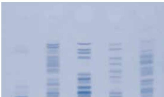
Трипсиновый гидролизат разных белков делили на ВЭТСХ пластине ProteoChrom® HPTLC с силикагелем 60 F<sub>254s</sub> после чего красили (А) флуорескаминем, или (В) нингидрином.
