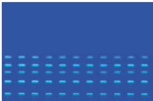
Сравнение разделения дансиламинокислот на классической ТСХ пластине и пластине для ВЭТСХ в одинаковых условиях. Сравнение демонстрирует, что на пластине ВЭТСХ зоны более четкие, а длина пробега меньше, следовательно, время анализа будет меньше. Кроме того, пластины ВЭТСХ позволяют делить в два раза больше образцов одновременно.
