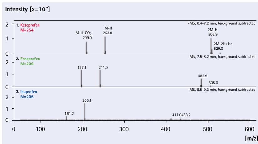
Кетопрофен, Фенопрофен и Ибупрофен (100 нг) не дают ложных пиков в MS спектре при использовании Ацетонитрила LiChrosolv® hypergrade и колонок Purospher® STAR RP-18 endcapped.
