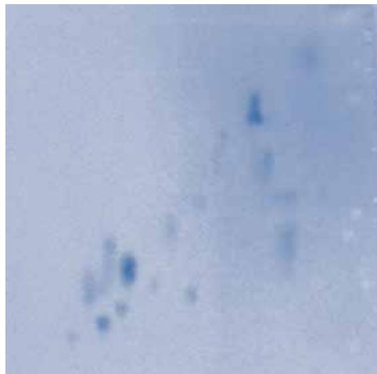
После двумерного разделения трипсинового гидролизата цитохрома С на ВЭТСХ пластине ProteoChrom® с целлюлозой, результат окрашивали (А) флуорескамин, или (В) нингидрином.
