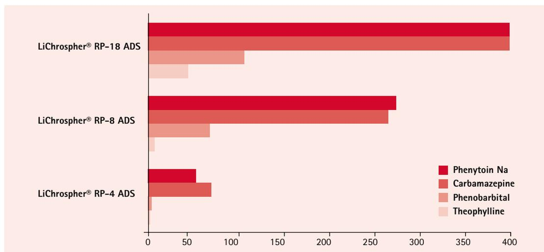
Предколонки LiChrospher® RP ADS с низкой гидрофобностью обладают большим преимуществом при нанесении аналита. Так, если очистка пробы осуществляется на предколонке LiChrospher® RP-8 ADS, а последующее хроматографическое разделение ведется на колонке с сорбентом RP-18, то появляется возможность уменьшить количество органической составляющей в элюенте, и сконцентрировать очищенную фракцию пробы на верхнем слое сорбента.
