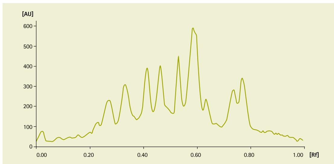
Денситограмма трипсिनного гидролизата  $\beta$ -Казеина. Трипсиновый гидролизат  $\beta$ -Казеина делился на ВЭТСХ пластине ProteoChrom® HPTLC с силикагелем 60 F<sub>254s</sub>, затем окрашивали флуорескаминем и сканировали с помощью CAMAG Scanner III в режиме флуоресценции при УФ 366.
