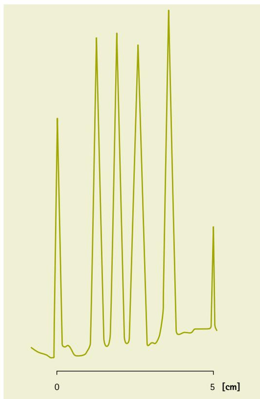
ОФ-модифицированные пластины хорошо подходят для анализа кислотных и основных соединений, как это показано на примере разделения галловой кислоты и ее эфиров на ВЭТСХ пластине с силикагелем RP-18 WF<sub>254</sub>.
