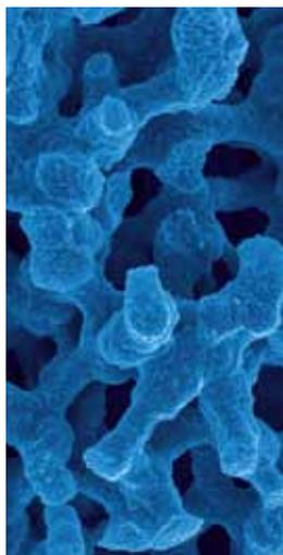
ВЭЖХ колонки Chromolith® обеспечивают отличное разделение за значительно более короткий период времени по сравнению со стандартными колонками, так как состоят из высокопористого монолитного стержня силикагеля с бимодальной структурой пор. **Колонки состоят не из частиц, а из единого куска высокочистого полимеризованного силикагеля.** ВЭЖХ колонки Chromolith® выпускаются в формате, уже готовом к использованию (дополнительные держатели не требуются).
