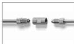
Соединение двух ВЭЖХ колонок LiChroCART® (длиной 75, 100, 125, 150 и 250 мм) при помощи соединителя [1.50083]
