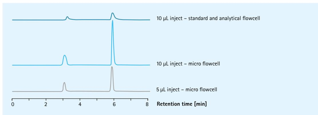
Эксперименты проводились на одной и той же системе с колонкой 150-2.1 мм.
