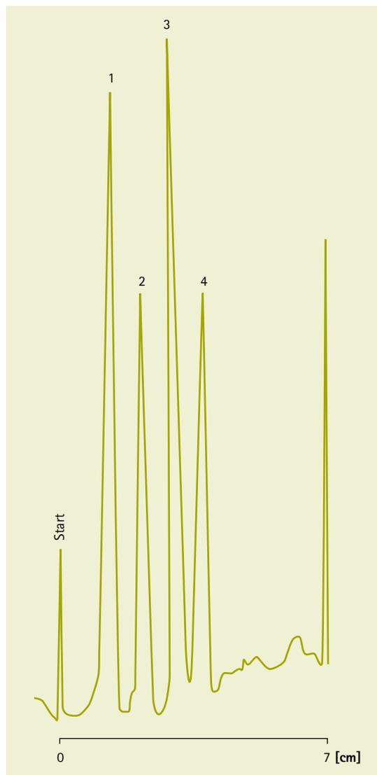
Разделение олигонуклеотидов на ВЭТСХ пластине с NH<sub>2</sub>-модифицированным силикагелем 60
