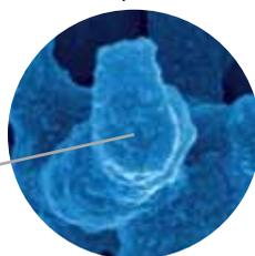
Мезопоры образуют тонкую пористую структуру (средний размер пор 13 нм) и создают большую однородную поверхность, на которой происходит адсорбция, тем самым обеспечивая высокую эффективность хроматографического разделения.
