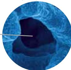
Макропоры обеспечивают высокую скорость потока подвижной фазы при низких давлениях. Их размер составляет 2 мкм.
