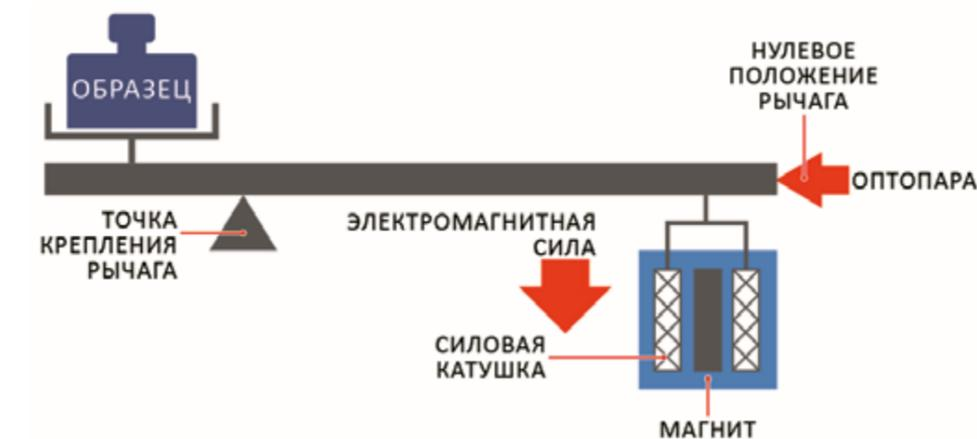
Такая система позволила добиться очень высокой точности и стабильности показаний, однако у нее есть и недостатки. Это в первую очередь высокая стоимость. Датчик технически сложен и крайне уязвим к перегрузке или неосторожному обращению. Для достижения точных и стабильных показаний датчику требуется прогрев от одного часа, а высокая
